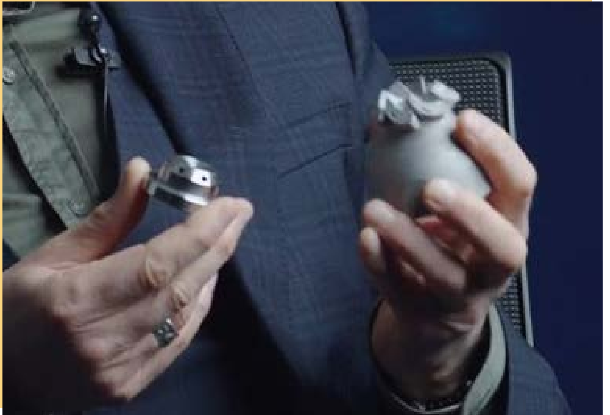
Orijinal yakıt atomizeri (sol), 3 boyutlu baskı yöntemiyle üretilmiş yakıt atomizeri (sağ)
