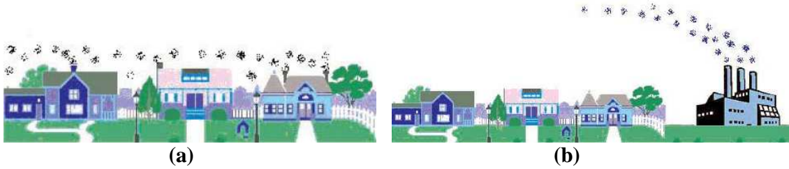
Şekil 8. (a) Yerel ısınma yapıldığında duman hemen yere çöker. (b) Bölge ısıtma sistemi uygulandığında duman geniş alana yayılır.
