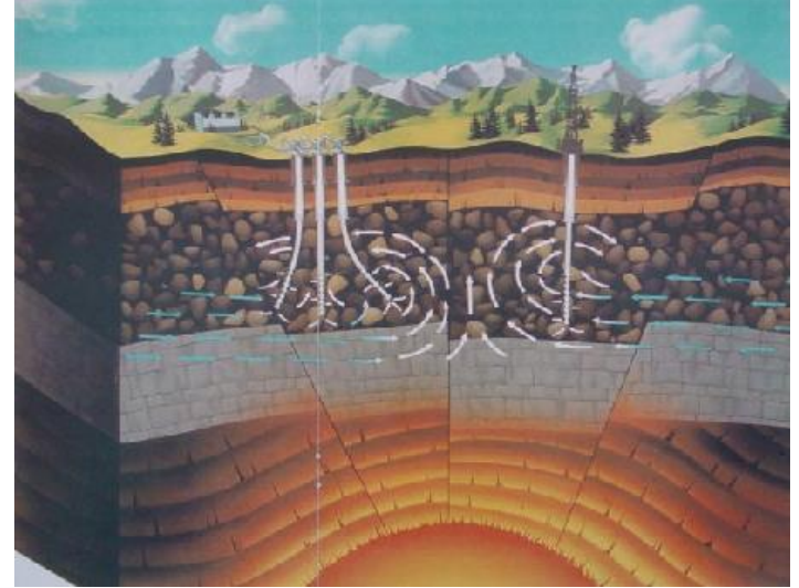
Jeotermal sistemdeki rezervuar, üretim ve reenjeksiyon
