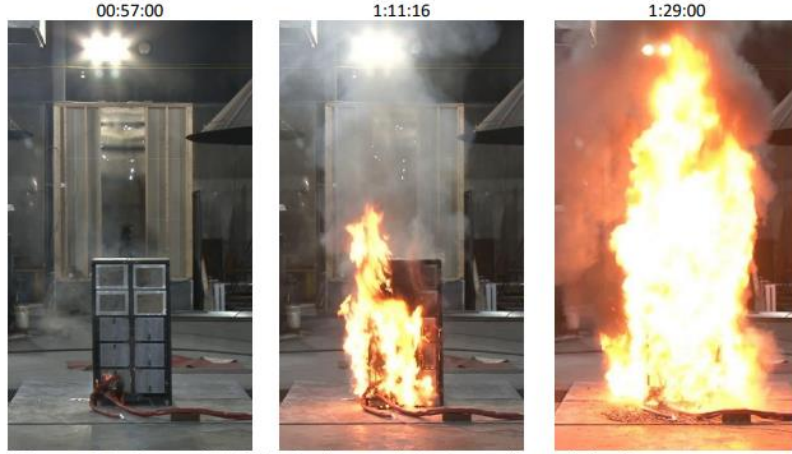
Şekil 5 Orta Ölçekli Serbest Yanma Testi Sırasında Yangın Gelişimi
