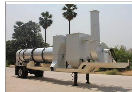
Resim 7. Mobil Asfalt Plenti [6, 8]
