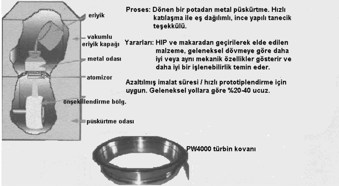
Şekil-6 Ringlerin Püskürtme Döküm ile İmalî Süreci (1)
