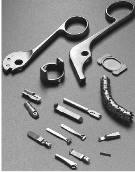
Şekil-5 Metal Enjeksiyon Döküm(MIM) kalıplama ile üretilen bazı ürünler ve geleneksel dövme yöntemi ile karşılaştırılması(1)
