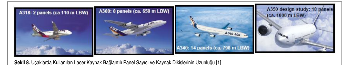
Şekil 8. Uçaklarda Kullanılan Laser Kaynak Bağlantılı Panel Sayısı ve Kaynak Dikişlerinin Uzunluğu [1]
