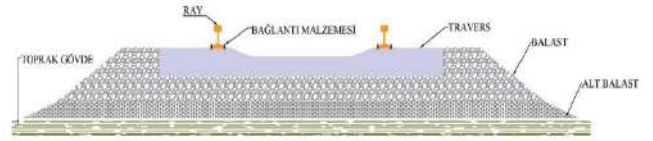
Şekil 1. Balastlı demiryolu üstyapısı kesiti
