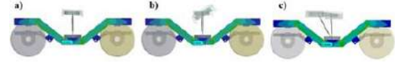
Şekil 9. Kuvvetin etki ettiği bölgeler a. Birinci durum (40 kg) b. İkinci durum (50 kg) c. Üçüncü durum (40+40 kg)
