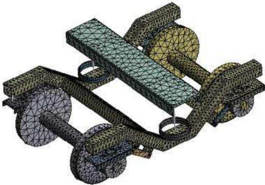
Şekil 8. Y32 bojisinin meshli görüntüsü
