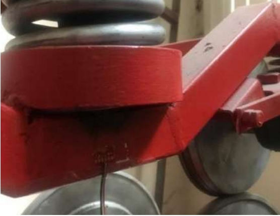
Şekil 6. Gerinim ölçer sensörünün tel ile birleştirilmesi
