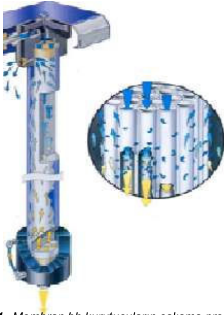
Şekil 5.1. Membran kurutucuların çalışma prensibi
