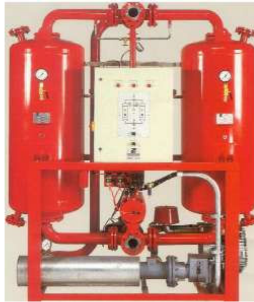
Şekil 3.7. Dıştan (elektrikli) ısıtıcı ABHK şeması ve resmi
