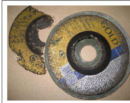
Şekil 5. Taşın Patlaması Sonucu Meydana Gelen Kaza
