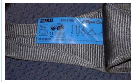
Resim 3. Sapan Etiketinin Arka Yüzü [2]
