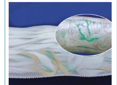
Resim 12. Nüvede Hasar veya Kırılma [5]
