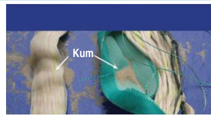
Resim 17. Kum Gibi Parçacıkların Nüfuz Etmesi [5]
