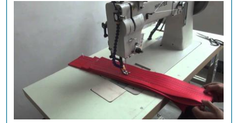
Resim1. Dokuma Sapanların Dikilmesi [1]
