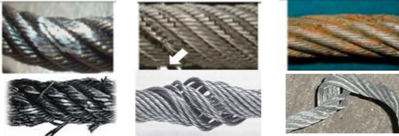
Şekil 2.22- Kullanılmaması gereken özürlü halatlara örnekler- Üst, soldan sağa; Ezilme, sürtünme; metal yorulması; korozyon Alt, soldan sağa; Aşırı yüklenme sonucu tellerde kopmalar; burulma sonucu kuş kafesi; düğümlenme - www.drillsafe.co.za
