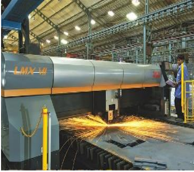
Şekil 5.4 – Lazerle kesme işlemi ve elde edilebilecek parça örneği
