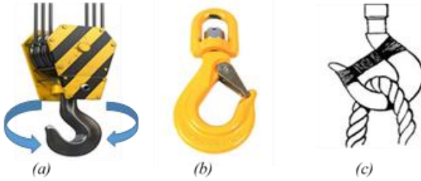
Şekil 2.30- Kancalar: (a) firdöndülü (b) mandallı; (c) bağ atılmış (moused)
