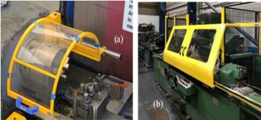
Şekil 3.8 – Operasyon noktasının görülmesine elveren saydam koruyucular.
