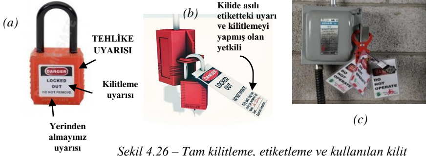
Şekil 4.26 – Tam kilitleme, etiketleme ve kullanılan kilit
