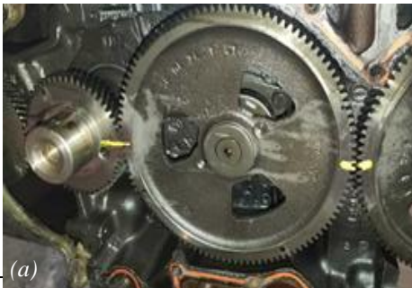
Şekil H.2- Doğru karşılatma yöntemleri: (a) İşaretleme (b) Karşılatma pimi
