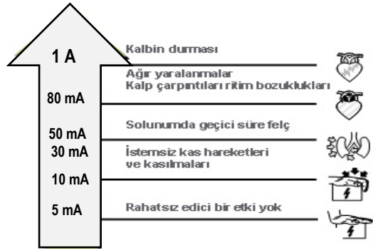
Şekil 2.14- Elektrikle temasın etkisi (b.b. elektrik)
