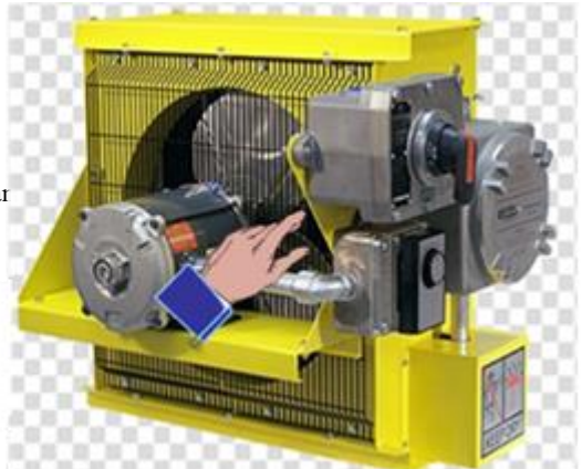
Şekil 4.1b- Hareketli elemanla mekanik temasın engellenmesi
