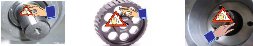
Şekil 3.2- takılma, kapma, dolanma tehlikesi olan durumlar
