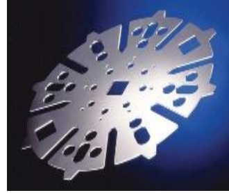
Şekil 5.4 – Lazerle kesme işlemi ve elde edilebilecek parça örneği
