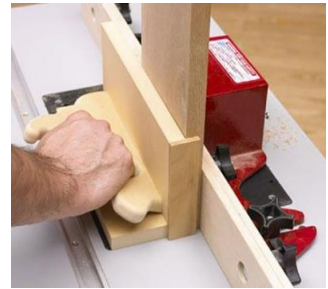
Şekil 4.29- İş parçasının güvenli biçimde kesici takıma sürülmesi
