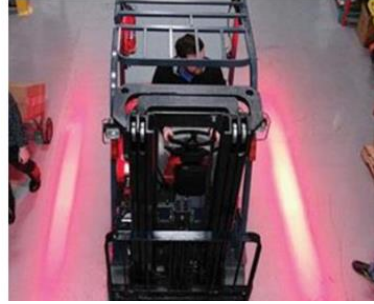
Şekil 2.19- Özel aydınlatma yoluyla tehlikeli bölgenin belirtilmesi.
