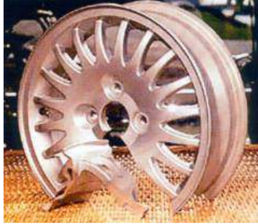
Şekil 12. Sürtünen Eleman ile Kaynak Yöntemi Kullanılarak Üretilmiş Tekerlek Jant Örneği.[8]
