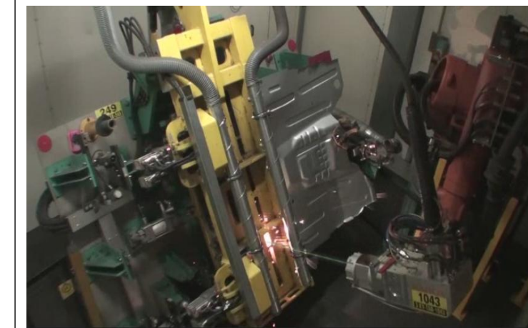
Şekil 11. Uzaktan Lazer Kaynak Yöntemi ile Araç Gövdesi Ön-Alt Taban Saclarının Kaynatılması (Ford Otosan, 2012)
