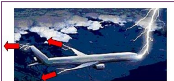
Şekil 1 . Yıldırım Çarpması Sonucu Akımın Uçak Yüzeyinden Atılması
