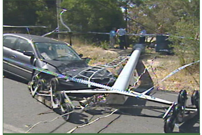
Şekil 2. Halatlı Taşıma Sistemindeki Direk Kazası
