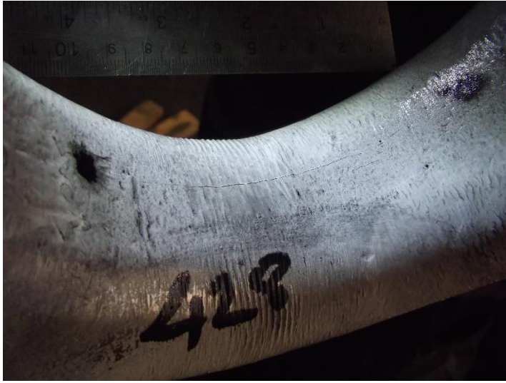
Kanca gövdesinde enine çatlak
