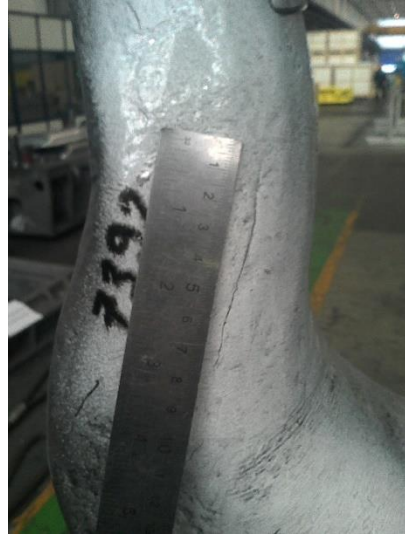
Kanca gövdesinde boyuna çatlak
