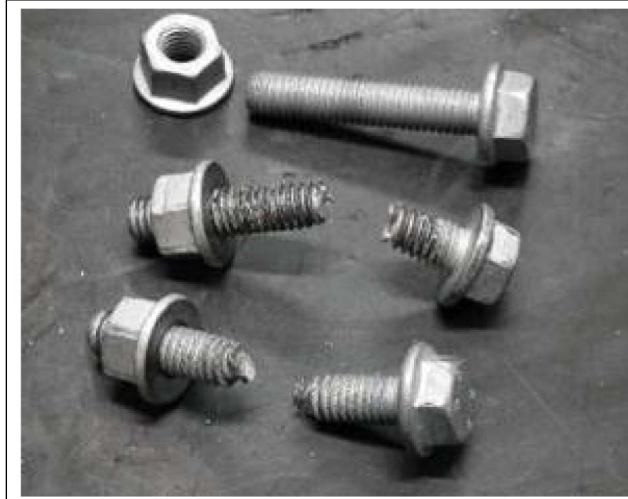
Şekil 8. Sıkma Momenti Karşısında Akma ve Kopma Noktasının Tespitinde Kullanılan Bağlantı Elemanları
