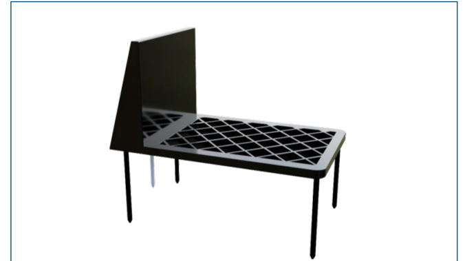
Şekil 10. Sıvı Tankı Yatağı (toprak altında kalan ayaklar ve tansiyonmetre ile birlikte görünümü)
