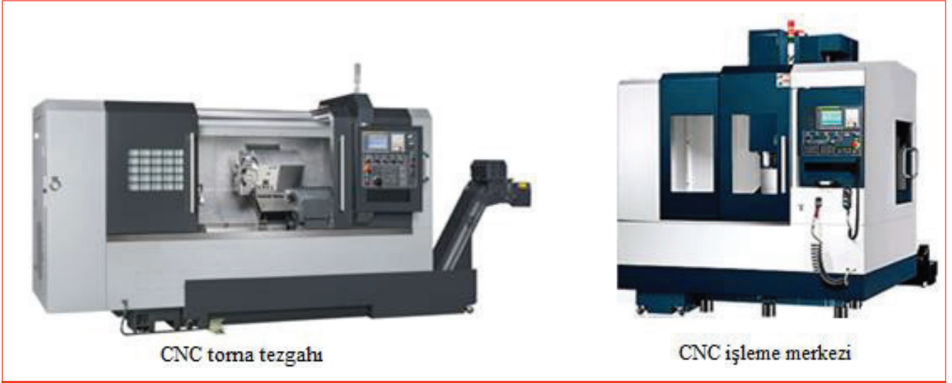
Şekil 4. Günümüzde Yaygın Olarak Kullanılan CNC Takım Tezgâhları
