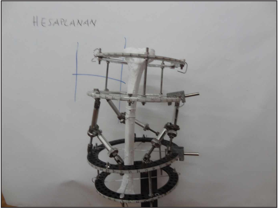
Şekil 41. Sağlıklı fiksator kurgusu (Birinci deney)
