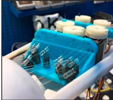
Şekil 7 Perspektif bakış açısından Yay ve Tendon Tutucular
