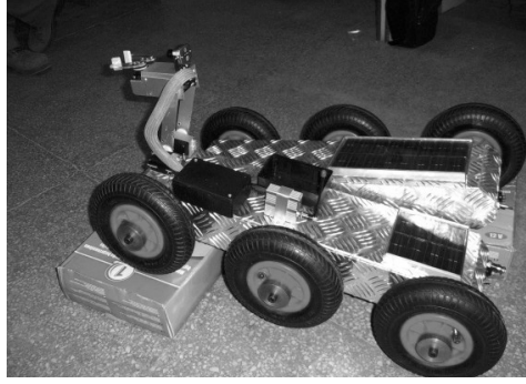
Bomba İmha Robotunun 6 Tekerli İlk Versiyonu
